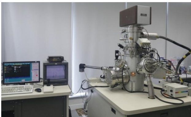
圖 1. PHI680 掃描俄歇納米探針
